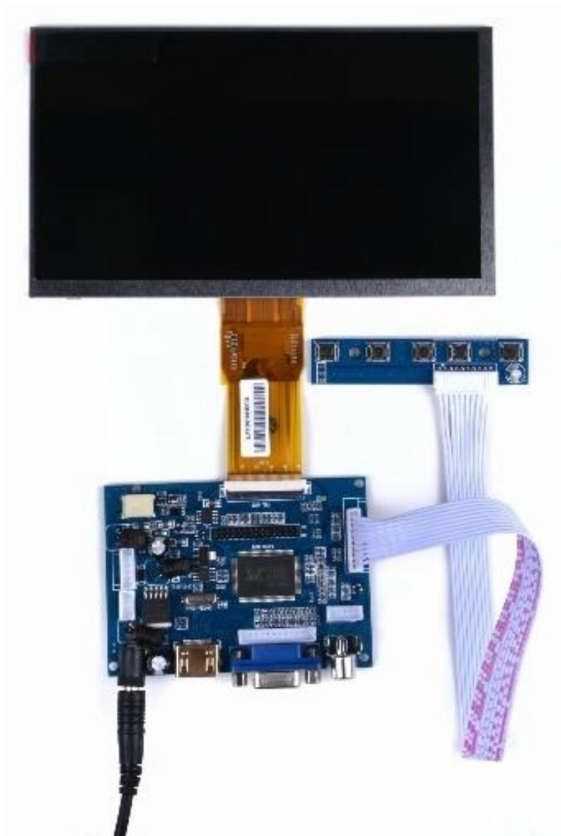
*Abbildung 34 – 7-Zoll LCD inkl. Treiberplatine und Eingabeplatine (52Pi, 2018)*
