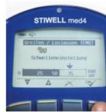
Die Trigger-Schwelle zum Auslösen des Stimulationsimpulses manuell mit + und - (oder Drehregler) einstellen und mit **OK** bestätigen
