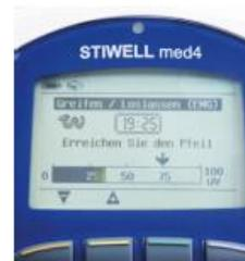
Die Muskelaktivität wird als gefüllter Balken angezeigt. **Versuchen Sie, durch Anspannen des Muskels den Balken bis zum Pfeil zu füllen.**
