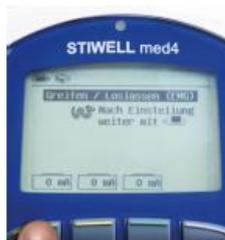
Zum Einstellen der Intensität die Funktionstasten **Ix** drücken - „0 mA“ beginnt zu blinken
