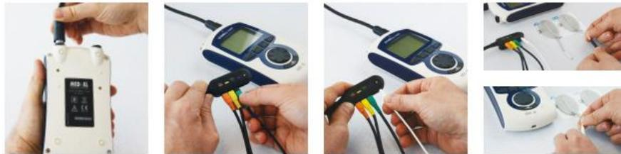
Hauptkabel an Buchse A anschließen
