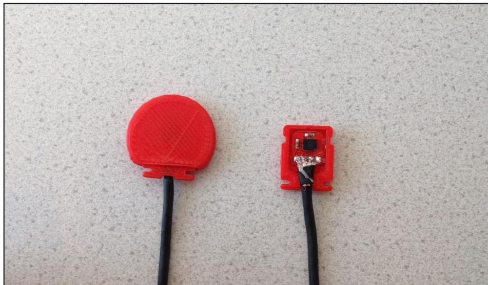
Abb. 8: Sensor mit und ohne Kunststoffhülse
