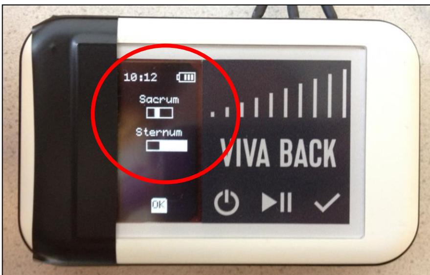
Abb. 6: *Positions-Helper* bei der Applikation der Sensoren
