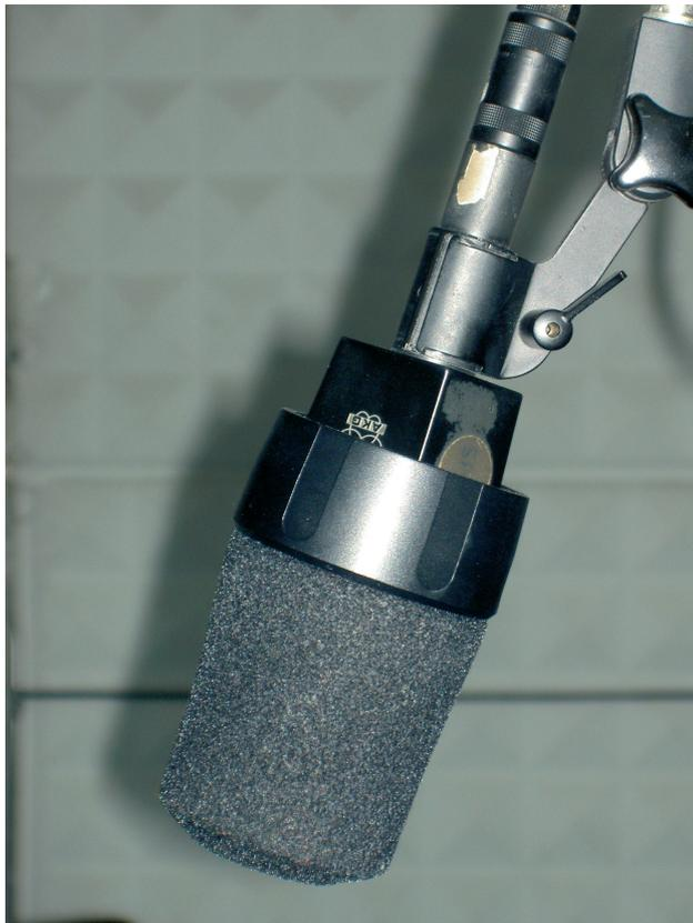
**Abbildung A.3:** AKG C414 mit Windschutz in Form eines Schaumstoffbezugs
