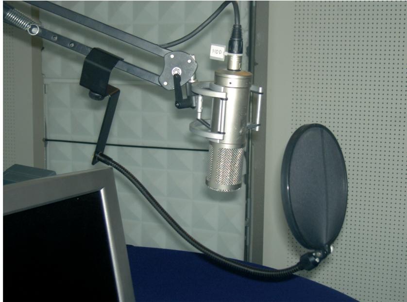
**Abbildung A.2:** Windschutz in Form eines Metallrings mit Nylonbespannung, montiert mit Hilfe eines Schwanenhalses
