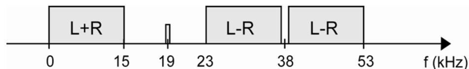
Abb. 29: Die Bestandteile eines UKW-Stereosignals [vgl. www17]
