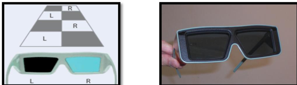
**Abb.13: Funktion der Shutterbrille (XPand)**
