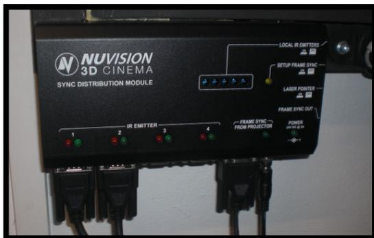
Das NuVision/Xpand-Gerät ist im Projektorraum aufgebaut und mit dem Projektor und dem Infrarotsender verbunden.
