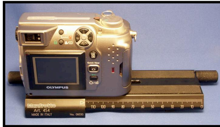
**Abb.7: Fotokamera auf einem Makroschlitten**
