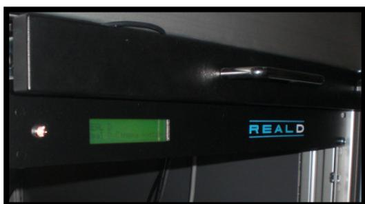
Mithilfe eines Steuerungsgerätes wird der Polarisationsfilter polarisiert. Mit den richtigen Polarisationsbrillen erlebt der Kinobesucher den 3D-Effekt.
