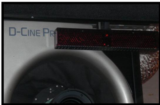
Der Infrarotsender sendet ein Infrarotsignal in den Publikumsraum und wird von der Leinwand wieder reflektiert. Die aktiven Shutterbrillen empfangen das Signal und steuern die LCD- Gläser.
