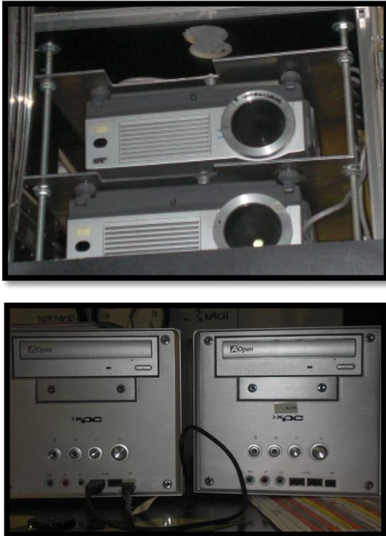
Die beiden Projektoren sind übereinander angeordnet und projizieren die Bilder auf die Leinwand. Vor den Objektiven befinden sich Polarisationsfilter.
