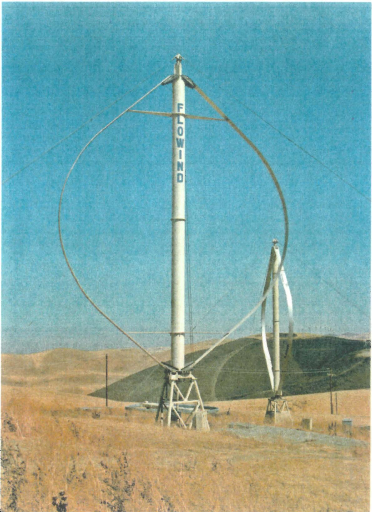
**Abb 7.** Darrieus-Windkraftanlagen der amerikanischen Firma Flowind: Rotordurchmesser 19 m, Nennleistung 170 kW, 1985 (Hau, 2016, S. 69)
