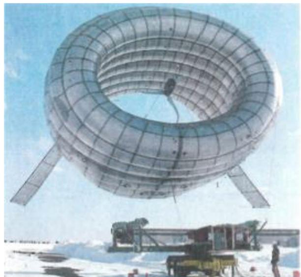
**Abb 9.** „Fliegende“ Windturbine von Alaero ausgelegt für 600 m Höhe, Nennleistung 100 kW (Hau, 2016, S. 80)
