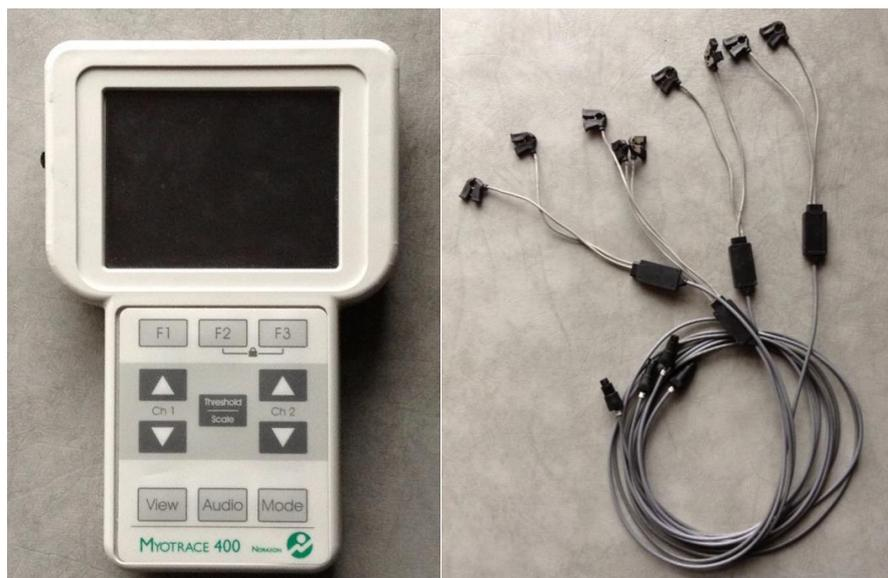
Abbildung 1: Kinesiologische Elektromyographie – Myotrace 400
