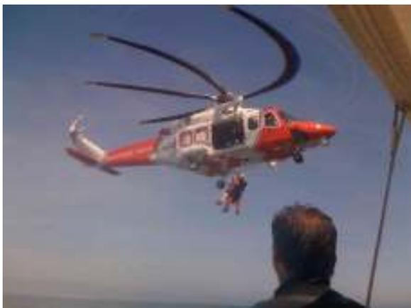
Abbildung 31: Rolling-Shutter-Effekt am Rotor des Hubschraubers, Quelle: [scorpionvision.co.uk/skewimage2.jpg](http://scorpionvision.co.uk/skewimage2.jpg)
