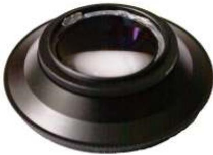
Abbildung 37: Geweitetes Raynox mit eingeklebter Zusatzlinse und Step-Down-Ring (58mm-52mm)
