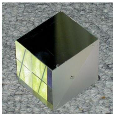
Abb. 8.6. - PBS mit Polarisationspiegel (Quelle: [www.hcinema.de](http://www.hcinema.de))
