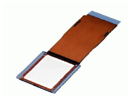
Abb. 8.3. - Foto eines D-ILA-Chips (Quelle: [www.hcinema.de](http://www.hcinema.de))
