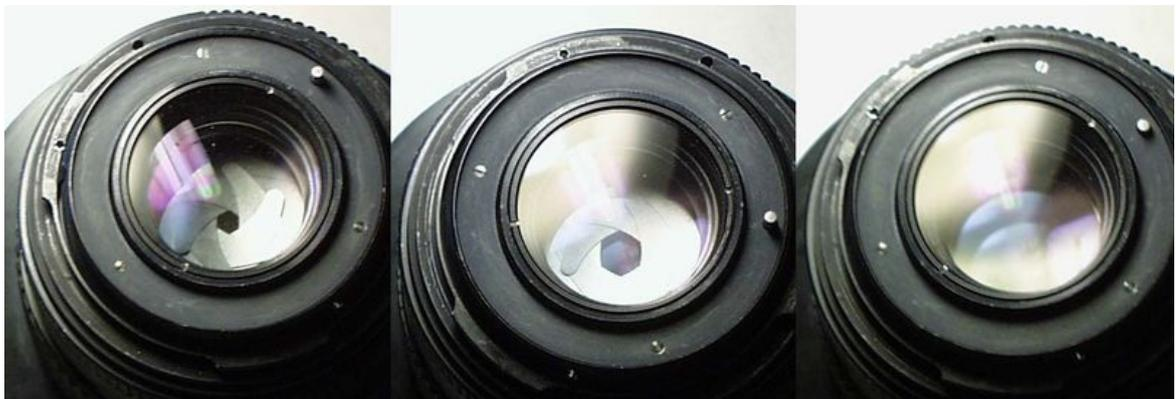
**Abbildung 7: Objektive mit verschiedenen geöffneten Blenden: Geschlossene Blende (f/22 links), Blende f/11 (Mitte) und offene Blende (f/3,5 rechts) im Vergleich<sup>10</sup>**
