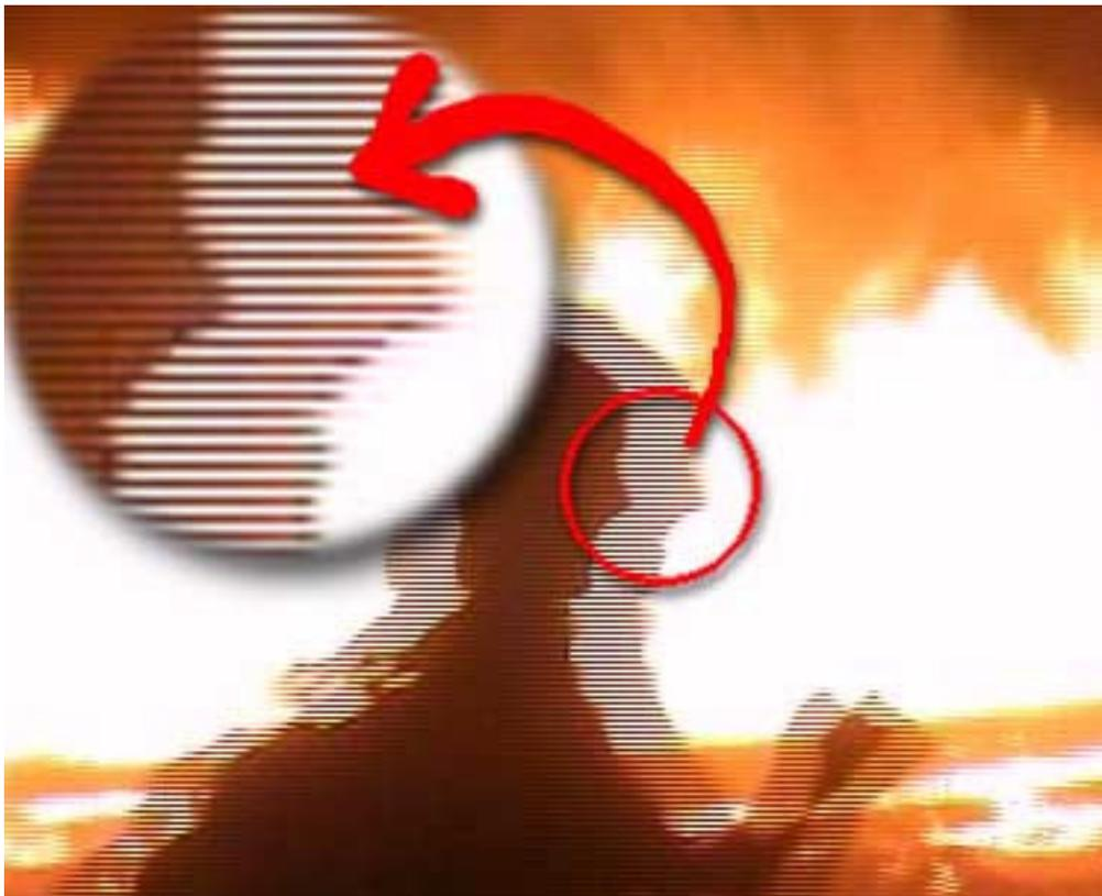
**Abbildung 8: Zeilensprungverfahren/Kammeffekt**
