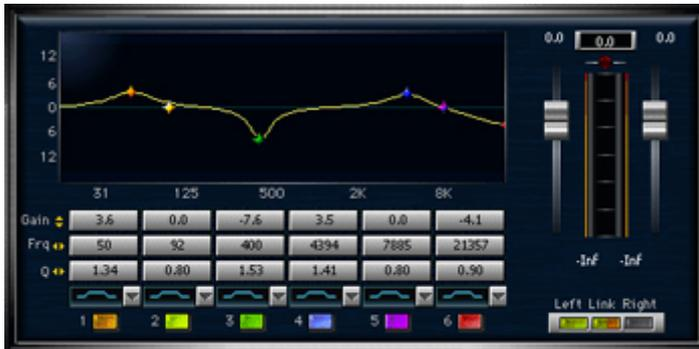
Abbildung 10.4: Waves REQ 6 bands auf der Kickdrumspur
