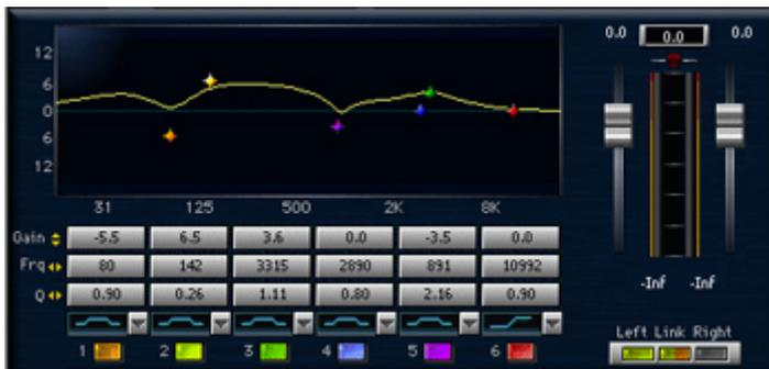
Abbildung 10.20: Waves REQ 6 bands auf der Guitar\_Rythm-Spur
