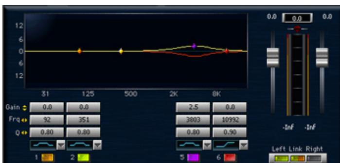
Abbildung 10.21: Waves REQ 4 bands auf der Guitar\_Rythm-Spur
