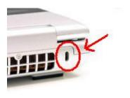
**Abbildung 2: Kensington Sicherheitsanschluss**
