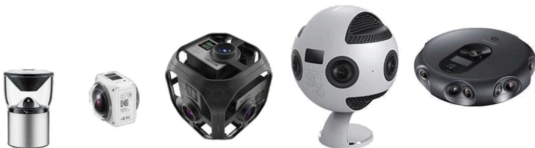
*Abbildung 2 Arten von 360° Kameras: (von links nach rechts) Omnidirektionale Kamera: VSN Mobil V.360 mit einer Linse und Spiegel, Kodak Orbit 360 4K mit einer Linse pro Seite, GoPro Camerarig mit sechs Kameras, Insta360 Pro mit sechs fix verbauten Linsen. Stereoskopische Kamera: Samsung 360 Round mit zwei Linsen pro Ausrichtung.*
