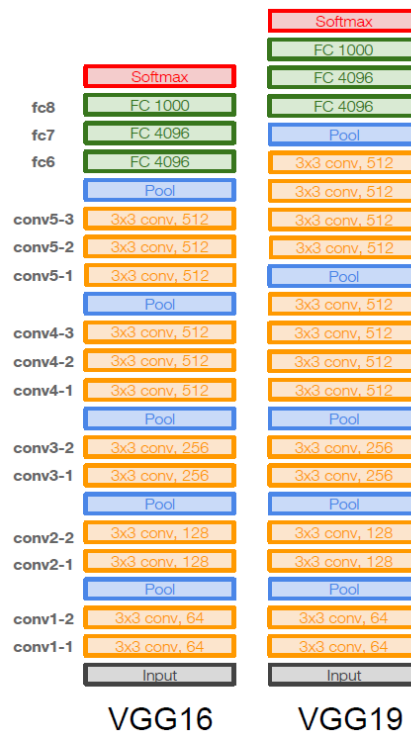
Abbildung 20: Schematisches Flussdiagramm wie die zu analysierenden Daten von unten nach oben durch die Ebenen des VGG16, sowie des VGG19 Netzwerks erfasst, analysiert, und weitergereicht werden. (Li et al., 2017)
