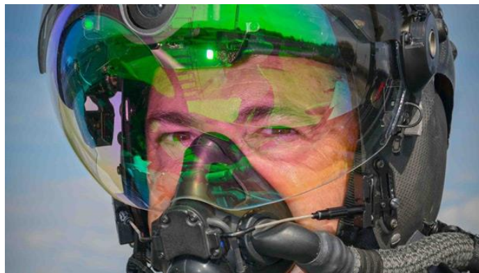
Abbildung 11: Head Mounted Display im BAE Striker II Kampfpilotenhelm (Smith, 2017)
